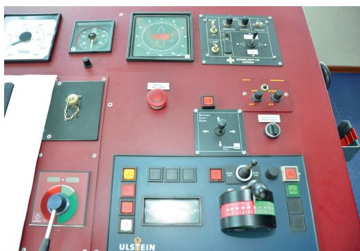
Spakarna vid manöverbordet som används vid tilläggning.
